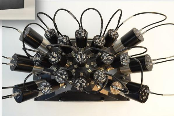
Meridian Starfield 安装座由一块厚金属板三维精密加工，精准三度空间定位加工孔位使目标投影仪的管能精准定位。这让重复测试时各个视场点的设置始终保持一致。当客户提供其相机镜的设计参数，或设计的 black box model，Optikos 能够设计独特的目标来补偿超宽视场相机的高失真视场点。
