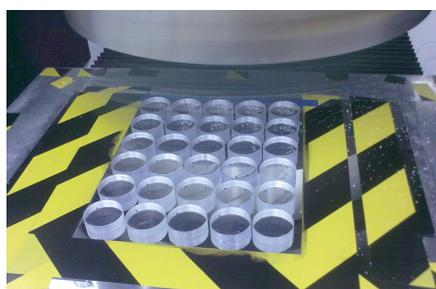
聚碳酸酯光学零件批量飞切加工，面形精度均优于0.7 μm
