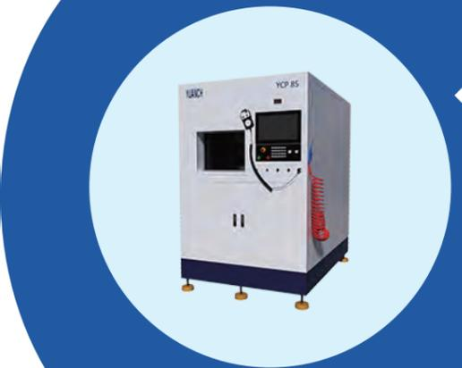
YCP-85立式抛光机是一种中小型立式光学零件加工机床，工件加工范围为10mm---85mm，工件在一次装夹后可自动连续地完成加工。适用于多品种、小批量的球面（非球面）光学元件抛光加工。
