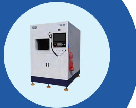
YCG-85立式铣磨机是一种中小型立式光学零件加工机床，工件加工范围为10mm---85mm，工件在一次装夹后可自动连续地完成加工。适用于多品种、小批量的球面（非球面）光学元件铣磨加工。
