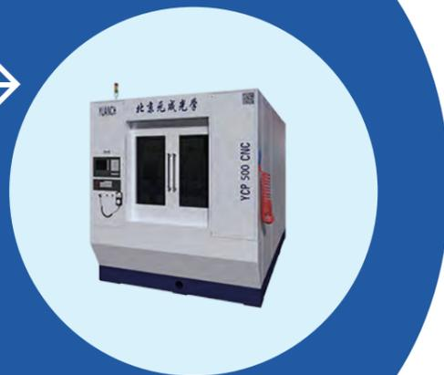
YCP-500抛光机是五轴数控自由曲面加工机床。加工工件外径范围为50---500mm，对称工件最大尺寸为520mm。加工精度 $\leq 3\mu\text{m}$ 。机床操作用中文界面，使操作更加便利，还可以装载专用的应用软件，生成专用的程序来加工工件。
